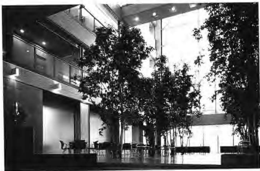
1 久米设计总部大楼的中庭。白天只有内藏式壁灯点亮，该灯为放在桌子上的色温3000K(开尔文)的卤钨灯。到了夜晚，顶棚上的遮阳布就将沿水平方向关闭，内部的基本照明，是用暖色金属卤化物灯(3500K)对该顶棚布进行照明。
