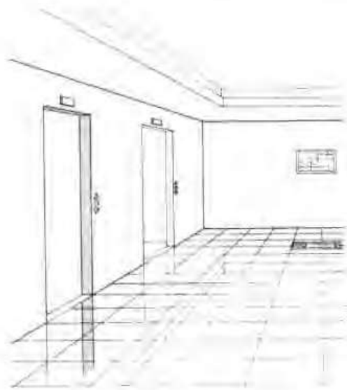
1 顶棚照明(2层发光灯槽顶棚)映照在有光泽的地板上，会使人感到晃眼，好像地面成阶梯状，特别不适合老年人的眼睛。
