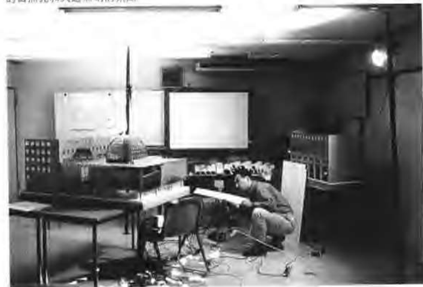
1-6 神奈川桑利德广场。缩尺模型的灯光模拟试验把人造照明用的光纤作为道具使用，目的是为了创造出具有指向性的射灯和天空光的间接照明。照片是正在模拟进入中庭的自然光和人造照明的氛围。
