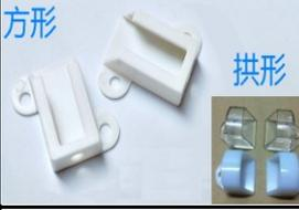
方形<br>拱形  | 名称:U型铝槽堵头<br>尺寸(L×W×H):30mm×35mm×9mm<br>材质类型: 工程塑料<br>固定孔径: 4mm<br>形状类型: 方形/拱形<br>固定在铝槽两端, 每根铝槽两只, 不分方向。                                           | 方形透明                 | ¥1.0  |
